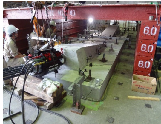
PC 鋼材を用いた載荷試験
