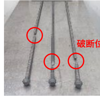
試験片の破断状況
