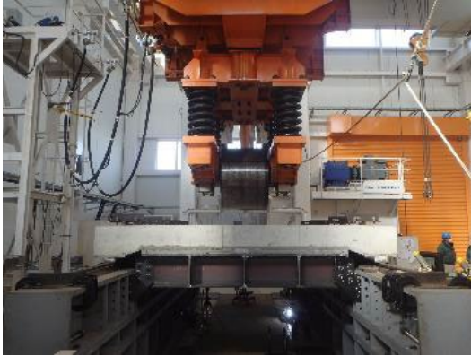
輪荷重載荷試験装置
